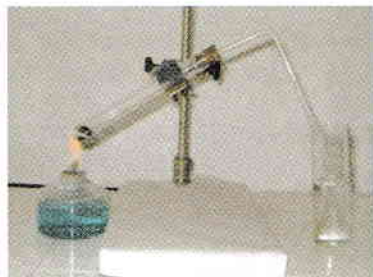
Fig. 1. 10. Instalație simplă pentru efectuarea analizei elementale.
